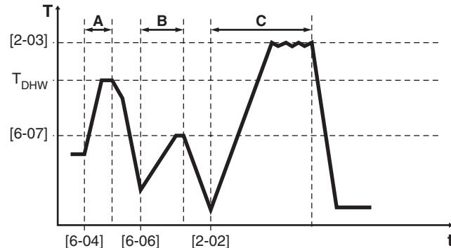
A Režim plánované akumulace: aktivovaný v [6-04], ohřívání horké užitkové vody, dokud nastavená hodnota uživatelského rozhraní horké užitkové vody  $T_{\text{DHW}}$  (např.  $55^{\circ}\text{C}$ ) není dosažena.
