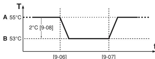
A Nastavená hodnota normální teploty výstupní vody nebo počítaná nastavená hodnota závislá na počasí
